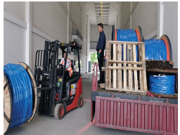
叉车---代替员工承运体积较大较重的电缆等原材料
